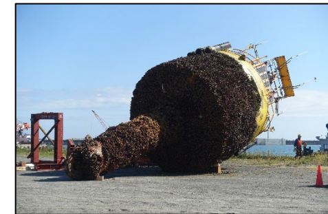
付着状況 (浮体全体)
