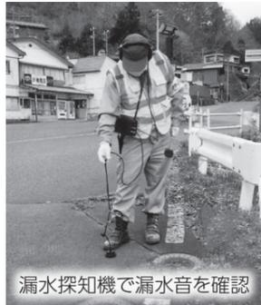
漏水探知機で漏水音を確認
