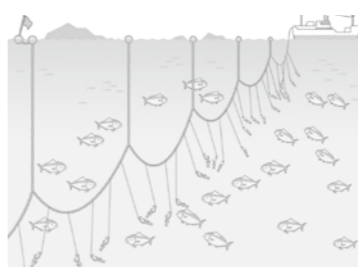
タラ延縄（はえなわ）漁業…1本の幹縄に多数の枝縄を付け、釣り針に餌を付けて引き上げる漁法。
